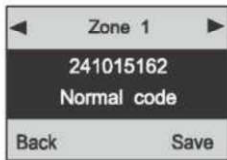
Рис. 4А: Сигнал от датчика распознан
