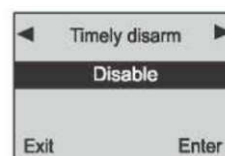
Рисунок 3: нажмите «б» для выбора пункта «Timely disarm»
