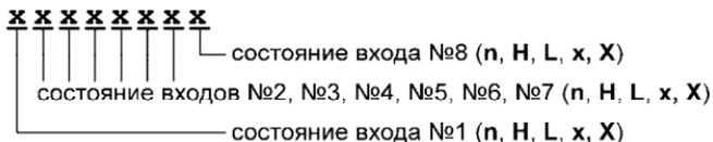
Состояние каждого входа отображается в виде символов:
