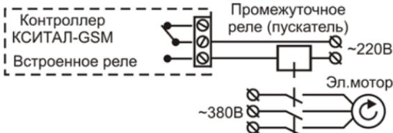
Если необходимо управлять мощными устройствами, то следует использовать промежуточные реле или контакторы соответствующего типа.
