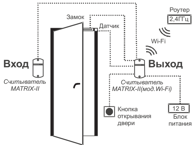
Рис.2 Схема подключения MATRIX-II (мод.Wi-Fi).
