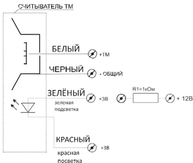
Рис.1 Схема считывателя электрическая, принципиальная
