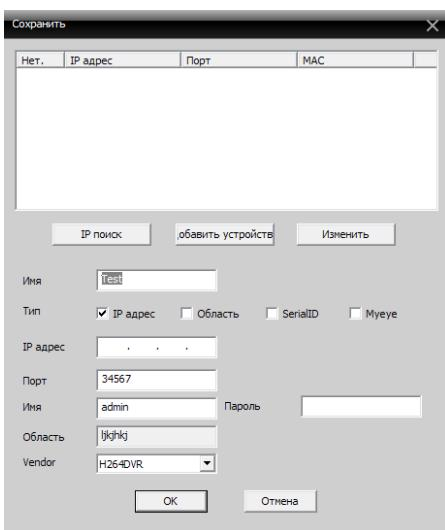
Имеется возможность автодиска подключенных устройств , после обнаружении устройств, программа добавит в список строку с IP адресом и портом найденной камеры. В строке «Имя» так же можно записать любое удобное для идентификации камеры имя (камера 1, офис, 2-й этаж и т.д.).
