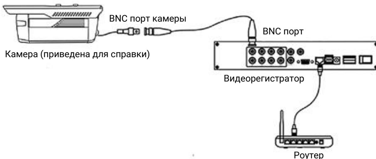
Камера (приведена для справки), разъем BNC (камера), разъем BNC, видеорегистратор, маршрутизатор.
