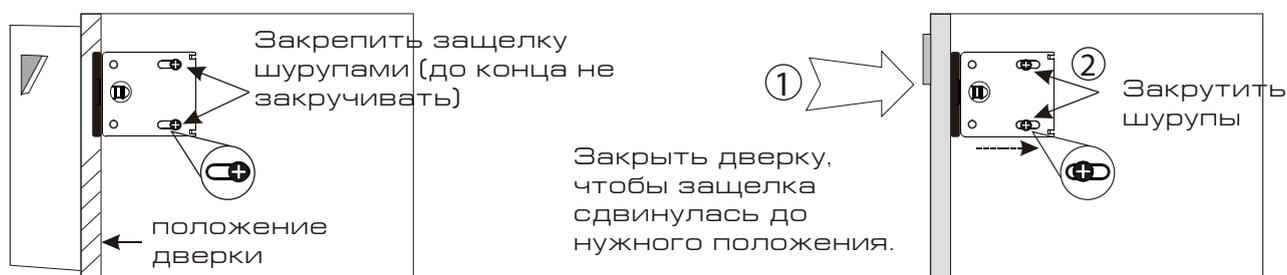
6. При открытии дверки, ответная часть с пластиковым штырем прилипает к дверке.
