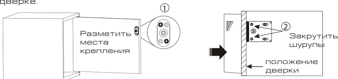
7. Заменить пластиковый штырь на металлический. Закрепить ответную часть.
