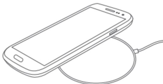
3. Для нормальной работы зарядного устройства мобильный телефон/планшет должен быть расположен точно по центру. Возможно, Вам понадобится несколько раз поменять положение мобильного телефона/планшета, пока на зарядном устройстве не загорится белый индикатор. Воспользуйтесь схемой, приведенной ниже, чтобы расположить мобильный телефон/планшет правильно.
