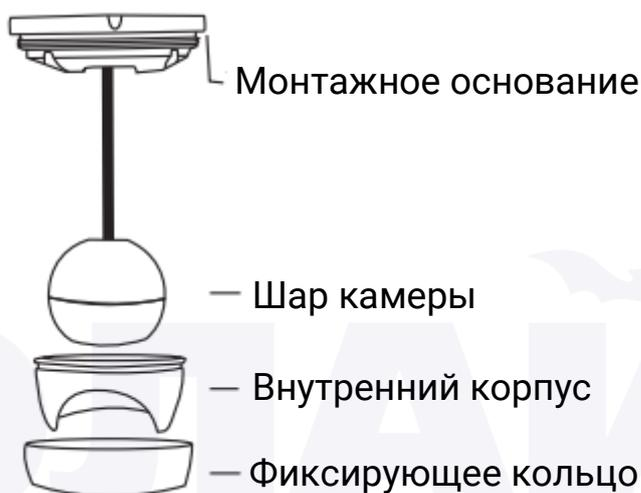
Четыре нижних монтажных отверстия должны быть установлены на плоской поверхности. Примечание: пожалуйста, не устанавливайте основания на неровной поверхности, так как это повлияет на надежность фиксации камеры. Учтите, что между основанием и куполом камеры проходит кабель, поэтому при установке основания удержите купол в руке так, чтобы не позволить кабелю провиснуть, как это показано ниже.
