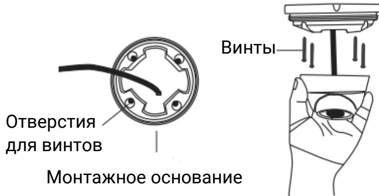
Зафиксируйте установочное кольцо на куполе камеры и внутренней крышке максимально плотно к основанию. Затем настройте положение купола камеры, как это показано ниже.
