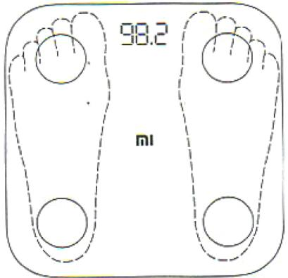
На дисплее устройства может появиться мигающий символ «OL» – весы сигнализируют о превышении максимально возможной массы. Допустимая цифра – до 150 кг.
