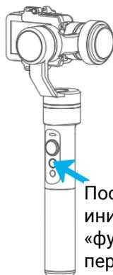
После успешного завершения инициализации нажмите кнопку «функции» для того, чтобы перевести стабилизатор в рабочий режим.
