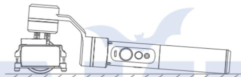
Расположите стабилизатор на плоской ровной поверхности (стол), чтобы внутренними сенсорами он зафиксировал состояние покоя. Синий индикатор мигнет три раза, после чего стабилизатор завершит инициализацию. Если световой индикации не произошло – значит инициализация завершилась ошибкой.
