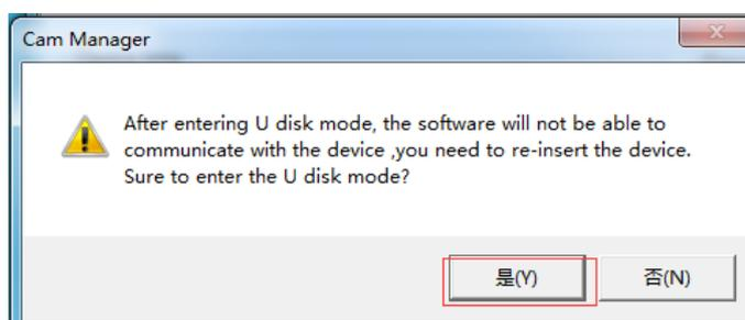
10. Нажмите “Yes” для подтверждения входа в U disk. Программа проверит диски компьютера, после чего перейдет к проверке регистратора. После этого выберите путь для сохранения файлов, загруженных из устройства.
