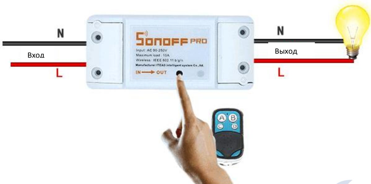
Быстро нажмите кнопку "SET" (настройка) дважды, на вашем устройстве Sonoff или Slampher, красный LED индикатор моргнет однократно, затем нажмите кнопку A, B, C или D на пульте управления на несколько секунд для сопряжения. Если вы сопрягли устройство с кнопкой A, вы сможете управлять им (включать/выключать) по нажатию на кнопку A.
