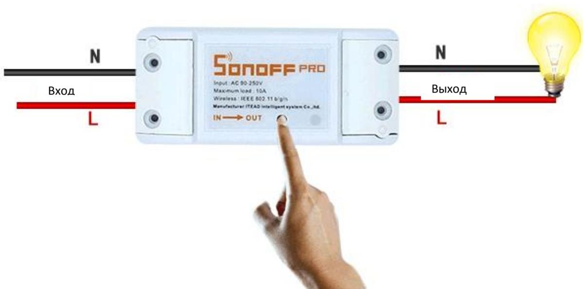
Для отмены сопряжения вам необходимо быстро нажать кнопку "SET" (настройка) трижды на вашем устройстве Sonoff/Slampher. Если вы однократно нажмете кнопку "SET" (настройка), оно будет выполнять функции выключателя – соответственно, включает или выключает устройство, подключенное к вашему Sonoff/Slampher.
