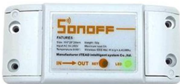
В режиме сопряжения устройств второго поколения: зеленый светодиодный индикатор мигнет три раза, как это показано ниже:
