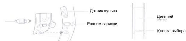
ⓘ Перед началом процесса зарядки просушите и очистите разъем, чтобы избежать загрязнения контактов или риска короткого замыкания. Если экран устройства не включается, необходимо зарядить или перезагрузить браслет
