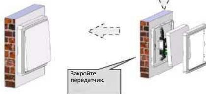
б. Установите передатчик с помощью клейкой ленты и прижмите его на 30 секунд в том месте, где вы хотите, чтобы он находился.
