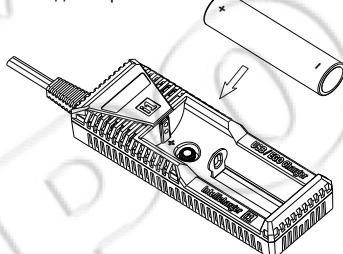
Вкрутите батарею EGO в гнездо (как показано на рисунке) и подключите устройство к розетке. При начале зарядки загорается красный индикатор, после окончания зарядки красный индикатор выключается и загорается зеленый индикатор.
