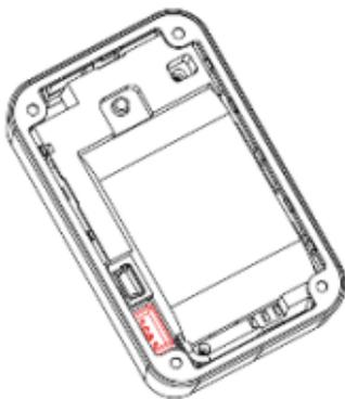
2. Извлеките элемент питания. Следуя указаниям на корпусе, установите SIM-карту.
