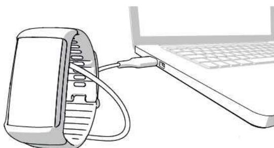
3. После синхронизации на дисплее начинает заполняться зеленый значок аккумулятора.
