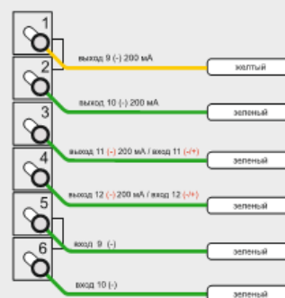
Разъем X 6 вид со стороны проводов
