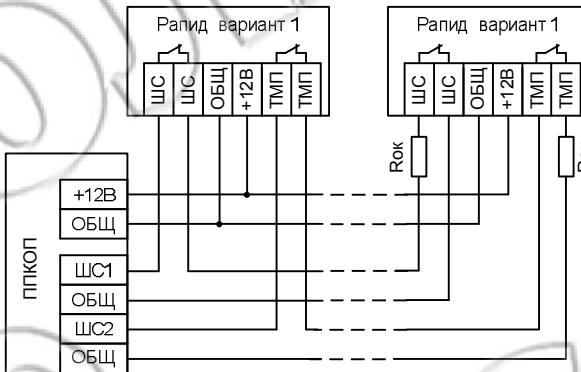
Рис.2 Схема подключения извещателей
