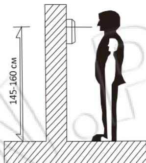
Оптимальная высота установки — 145 ~ 160 см от центра экрана до земли (данная информация носит справочный характер).
