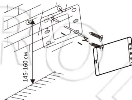
С помощью двух винтов нужно закрепить на стене кронштейн, а затем установить домофон.
