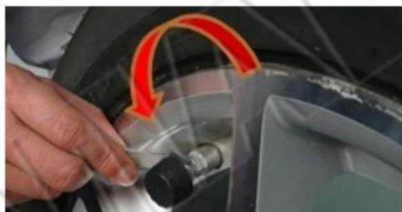
5. Проверить, не пропускает ли воздух соединение датчика с вентиляем камеры.
