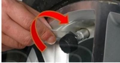
2. Снять датчик с вентиля камеры.
