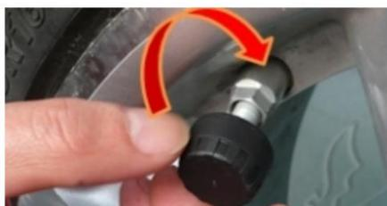
4. Используя гаечный ключ, закрутить гайку против часовой стрелки по направлению к датчику.
