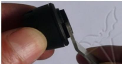
4. Извлечь разряженный элемент питания и, соблюдая полярность, установить новый.
