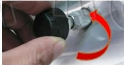
3. Используя гаечный ключ, отсоединить по часовой стрелке корпус датчика.
