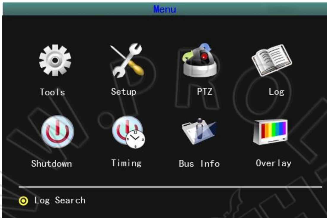
Сюда входят следующие элементы: Tools (инструменты управления); Setup (системные настройки); PTZ (управление PTZ); Log (журнал событий); ShutDown (завершение работы системы); Timing (настройки расписания); BusInfo (информация о шине данных) и т.д.
