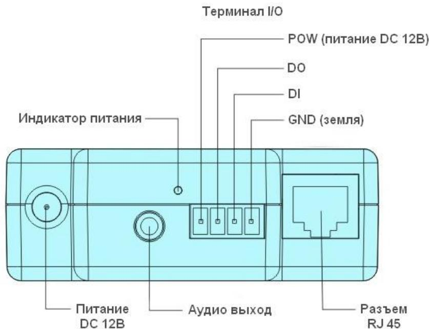
POW – выход для подключения питания внешних устройств DC 12В ±10%, макс. ток 0.4A.
