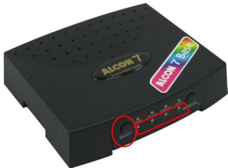
5. Если в вашей сети работают несколько переносных телефонных трубок, тогда, чтобы выбрать, с какой из них связаться, нужно нажать кнопку Select. Последовательно нажимая её, можно выбрать любую из четырёх трубок. Выбрав нужный модуль, нажмите кнопку Int — связь установится только с ним.
