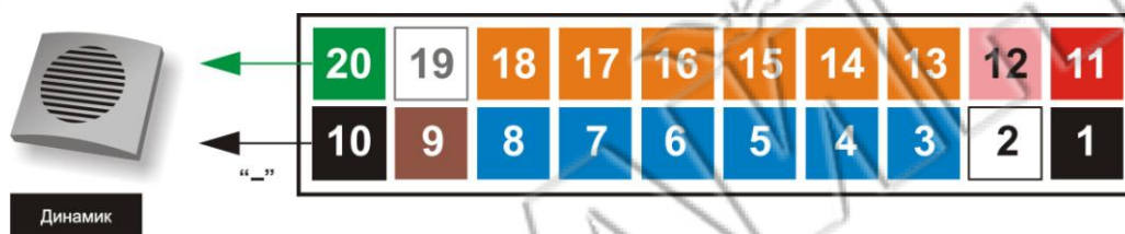
Рис. 7 Схема подключения внешнего акустического устройства
