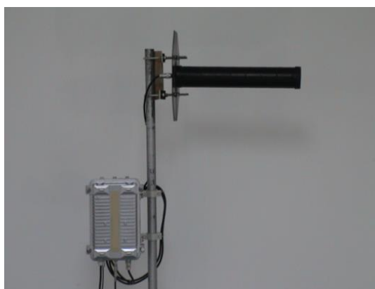
Рисунок 7. Монтаж системы (антенна с круговой поляризацией).
