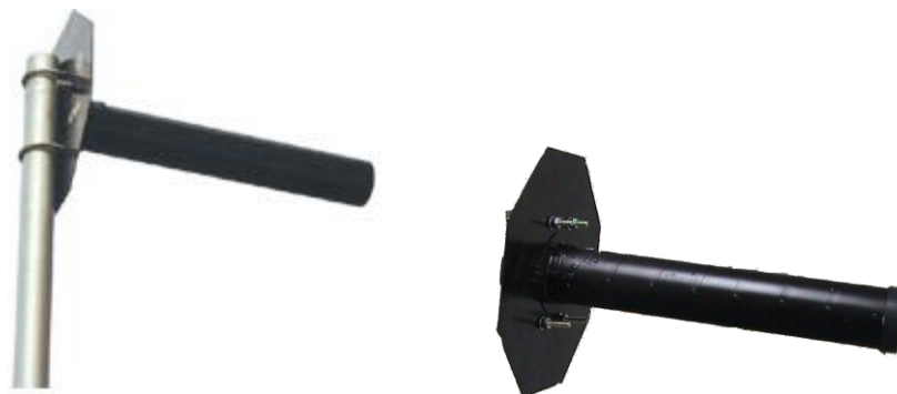
Рисунок 6. Внешний вид и монтаж спиральной антенны L-диапазона.
