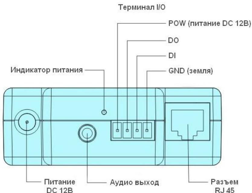
POW – выход для подключения питания внешних устройств DC 12В ±10%, макс. ток 0.4А.
