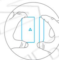
После разъединения передатчика и магнита индикатор загорится красным.
