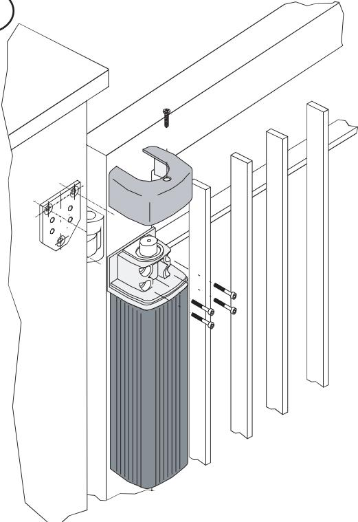
4) Используя четыре болта, поставляемые в комплекте , установить привод на монтажное основание. Установить верхнюю крышку на привод и закрепить ее с помощью винта.
