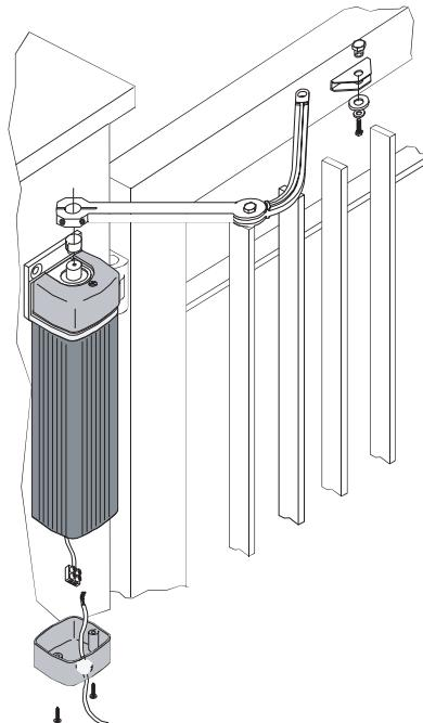
5) Установить сначала втулку на вал привода, а затем прямой рычаг и закрепить его с помощью торцевого болта.
