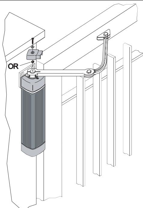
6) Подать электропитание на привод. Выполнить несколько циклов (открывание/закрывание) и убедиться, что вал привода останавливается, когда створка ворот доходит до механических упоров при открывании и закрывании. Если вал прокручивается, произвести повторную затяжку винтов крепления рычага к валу.
